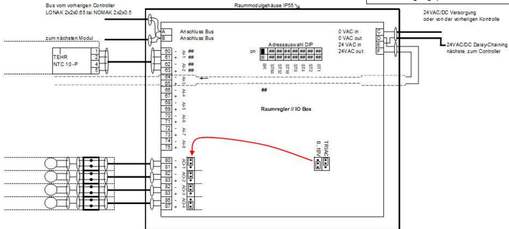
Input 1-6 nur Ohm Messung 10bit/0-32767 Ohm
